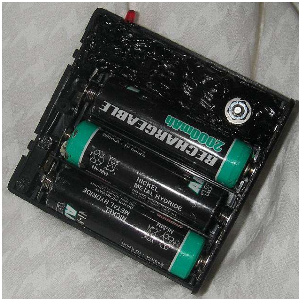
Vue détaillée du montage occupant un logement de pile et noyé dans du mastic noir, marine.
